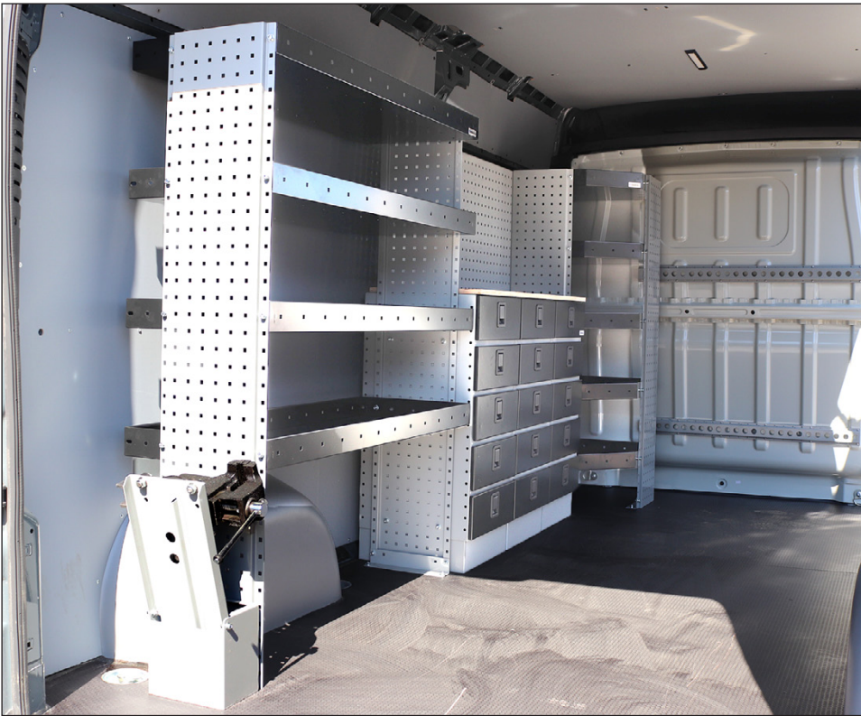
Huoltoautokalusteet tuplaavat auton tilan ja myös tehostavat työntekoa kohteessa. Änäkkälän kalusteet ovat modulaarisia eli niistä voidaan kasata erilaisia yhdistelmiä.
